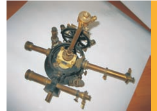
A kolozsvári Süss Nándor egyik mágneses mérőműszere (deklinómétere)
